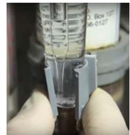
Un flujo continuo de la muestra por el tubo previene la contaminación por el oxígeno atmosférico. Cuando
