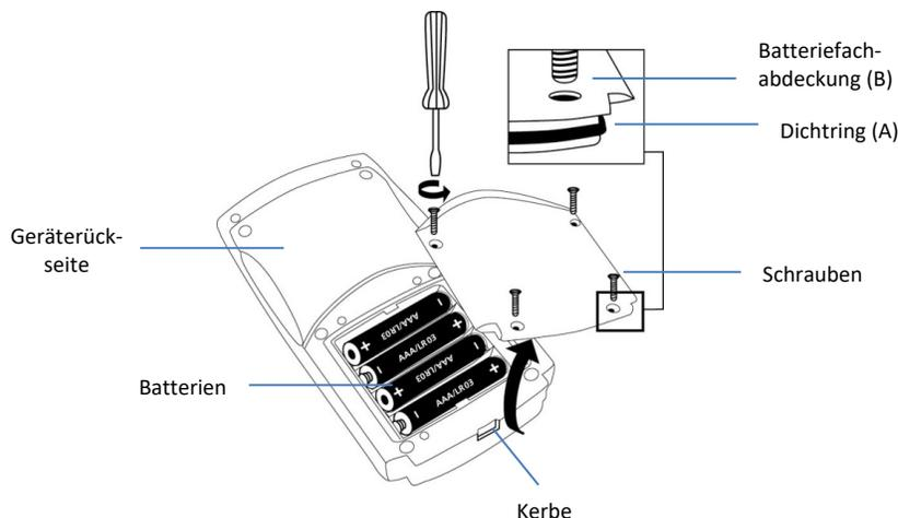
Um sicherzustellen, dass das Gerät wasserdicht ist:
