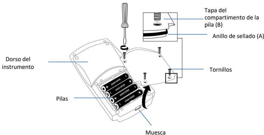
Para asegurarse de que el instrumento sea impermeable:
