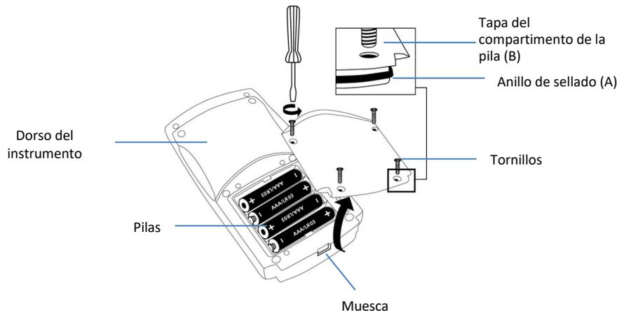
Para asegurarse de que el instrumento sea impermeable:
